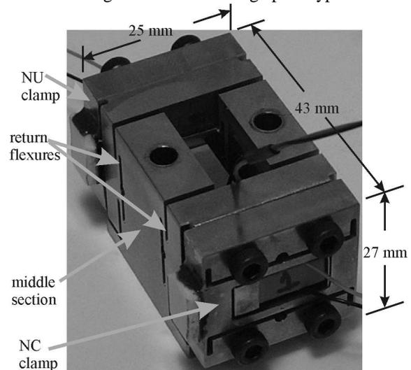
Fig 2. Piezoworm actuator.
